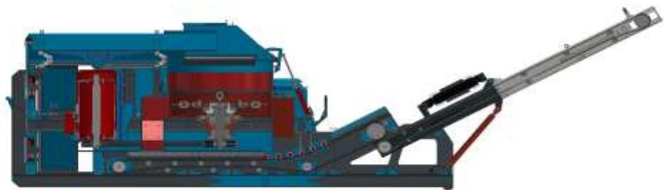
Abbildung 11: transportable Altdeponiebearbeitungsanlage der Firma WINCON
